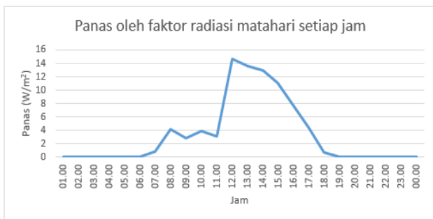
Gambar 6 Panas saluran oleh faktor radiasi matahari
