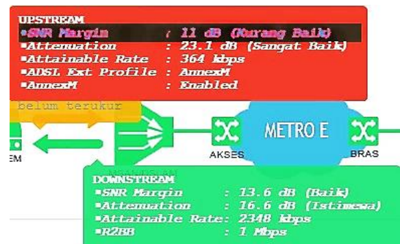
Gambar 3 Tampilan Pengukuran SNR dan Redaman pada IBooster [11]
