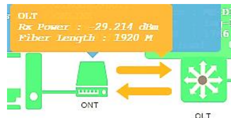
Gambar 4 Tampilan Pengukuran Rx Power pada IBooster [11]
