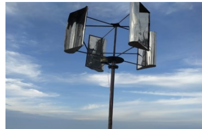
Gambar 5 pengujian kinerja alternator yang telah dihubungkan pada turbin angin di lapangan
